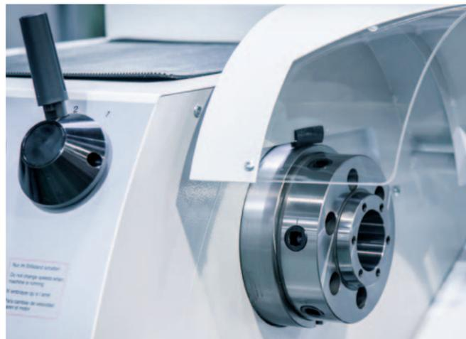
**Sicherheit.** Zur Sicherheit sind der Futterschutz und der Räderdeckel durch elektrische Schalter überwacht. Hauptspindel DIN 55029 S5, 50 mm Spindelbohrung.
