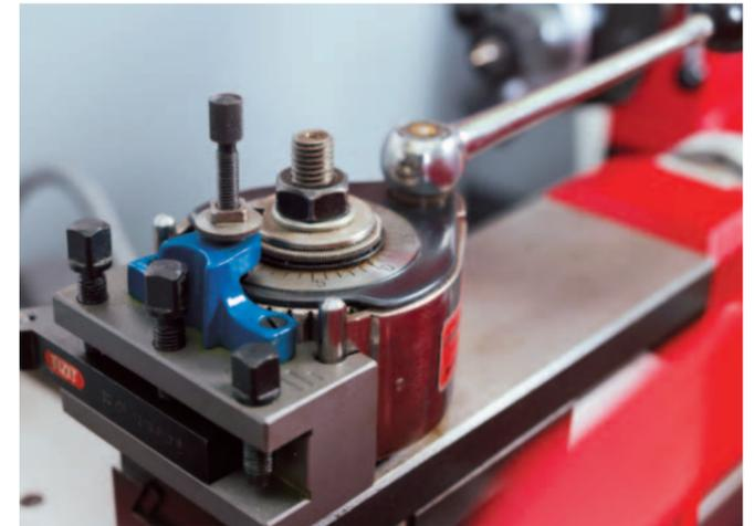
**Werkzeughalter-Schnellwechselsysteme.** Um den Bearbeitungsprozess zu beschleunigen, stehen verschiedene Werkzeughaltersysteme zur Verfügung. Der schnelle Wechsel von Werkzeugen ist damit gesichert.
