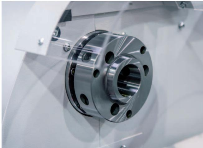
**Sicherheit.** Zur Sicherheit des Bedienpersonals sind der Futterschutz und der Räderdeckel durch einen elektrischen Schalter überwacht. Hauptspindel Camlock DIN 55029 S4, 40 mm Spindelbohrung.
