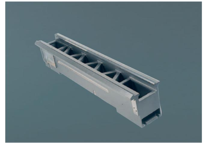
**Maschinenbett.** Die Diagonalverrippung des Maschinenbetts sorgt für guten Spänefall und optimale Stabilität der Maschinen. Die Führungsbahnen sind gehärtet und geschliffen. 3-Punkt-Auflage am Maschinenuntersatz.
