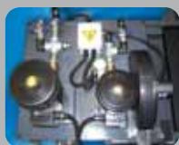
Getrennte Pumpen für Bett- und Werkstückspülung
