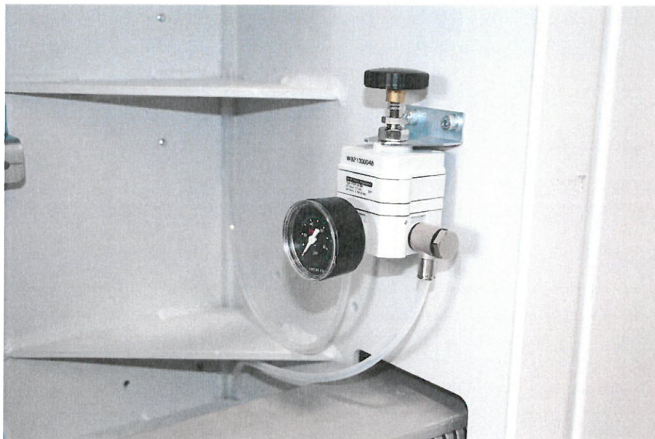
Blick auf den Druckausgleichs Regler für das Schleifaggregat unten.
