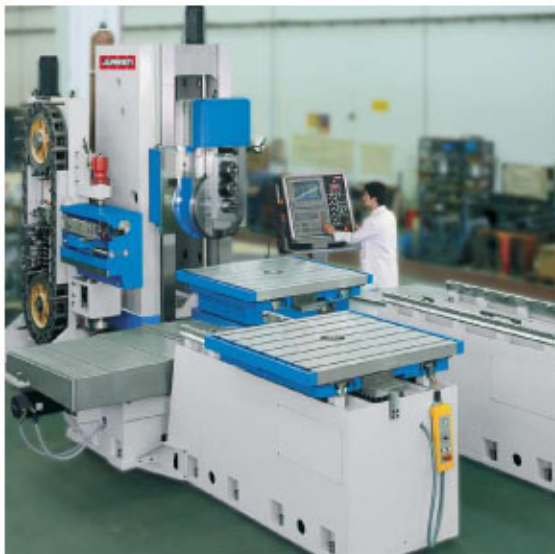
Macchina con testa a sfacciare CNC cambio pallets.
