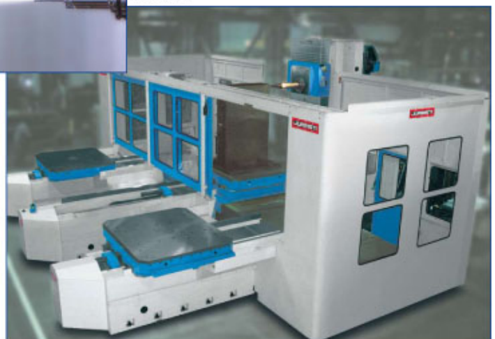
Carenatura completa con porte automatiche e pallets.
