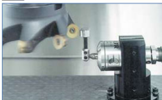
Sonda di misurazione pezzo.
