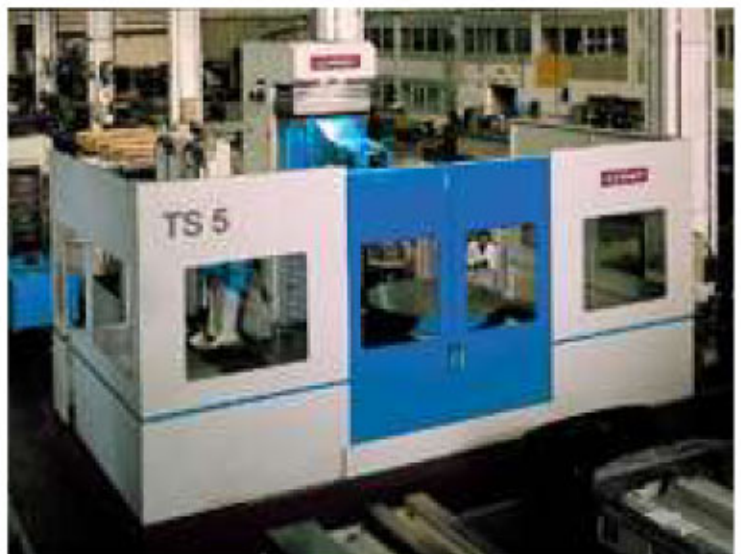
Macchina con carenatura chiusa e testa Twist.
