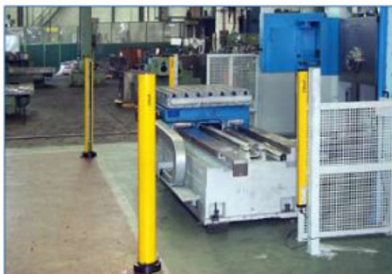
Protezioni con fotocellule.
