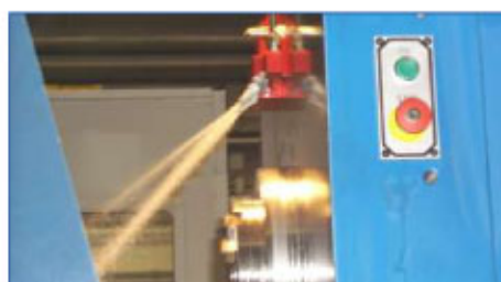
Refrigerazione esterna con controllo della direzione del getto.
