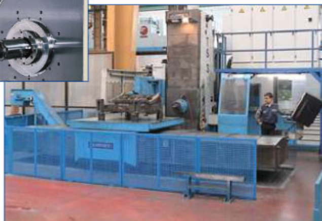
Carenatura C.E. e sistema di refrigerazione.
