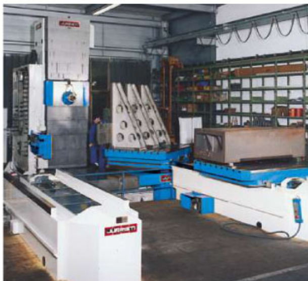
Macchina TS 5 con cambio automatico di pallets.
