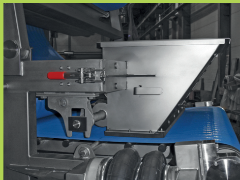
Großzügig dimensionierter Einfülltrichter mit Füllstandüberwachung
