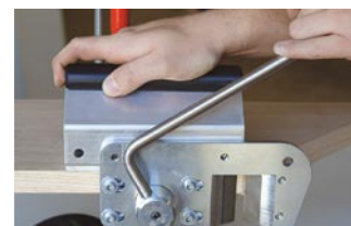
Max. wysokość cięcia: 50mm, grubość okleiny do 3 mm.
