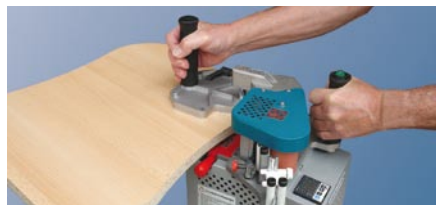
Oklejanie obrzeży na częściach prostych i krzywoliniowych
