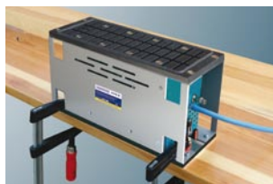
Na nierównych powierzchniach uchwyt może być mocowany za pomocą zacisków śrubowych.
